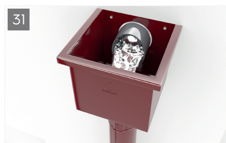
31 Permite preluarea apei din dolia fără streșini sau în cazul acoperișurilor plate unde evacuarea apei se face prin perete și direcționarea acesteia în burlan. Piesa este dotată cu dublă ranforsare pentru o mai bună rigiditate și rezistență.
