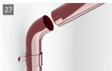
27 Îmbinarea unui prelungitor burlan (PB)/ burlan (BU) cu un cot burlan (CB) este ușoară datorită capătului ambușat al prelungitorului/ burlanului ce are diametru mai mic decât diametrul cotului burlan (CB), tocmai pentru a permite conexiunea între ele.
