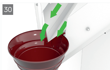
30 Cu ajutorul pâinii colectoare (PC), apa poate fi evacuată din dolia fără streșini și direcționată în burlan (BU). Piesa este dotată cu dublă ranforsare pentru o mai bună rigiditate și rezistență.
