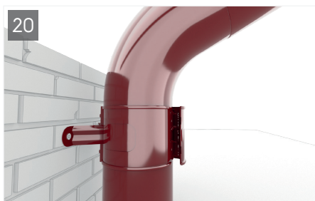
20 Brăjările burlan sunt fixate prin metoda click, prin simpla apăsare a lor, astfel încât după fixare ele să nu poată fi deschise accidental.
